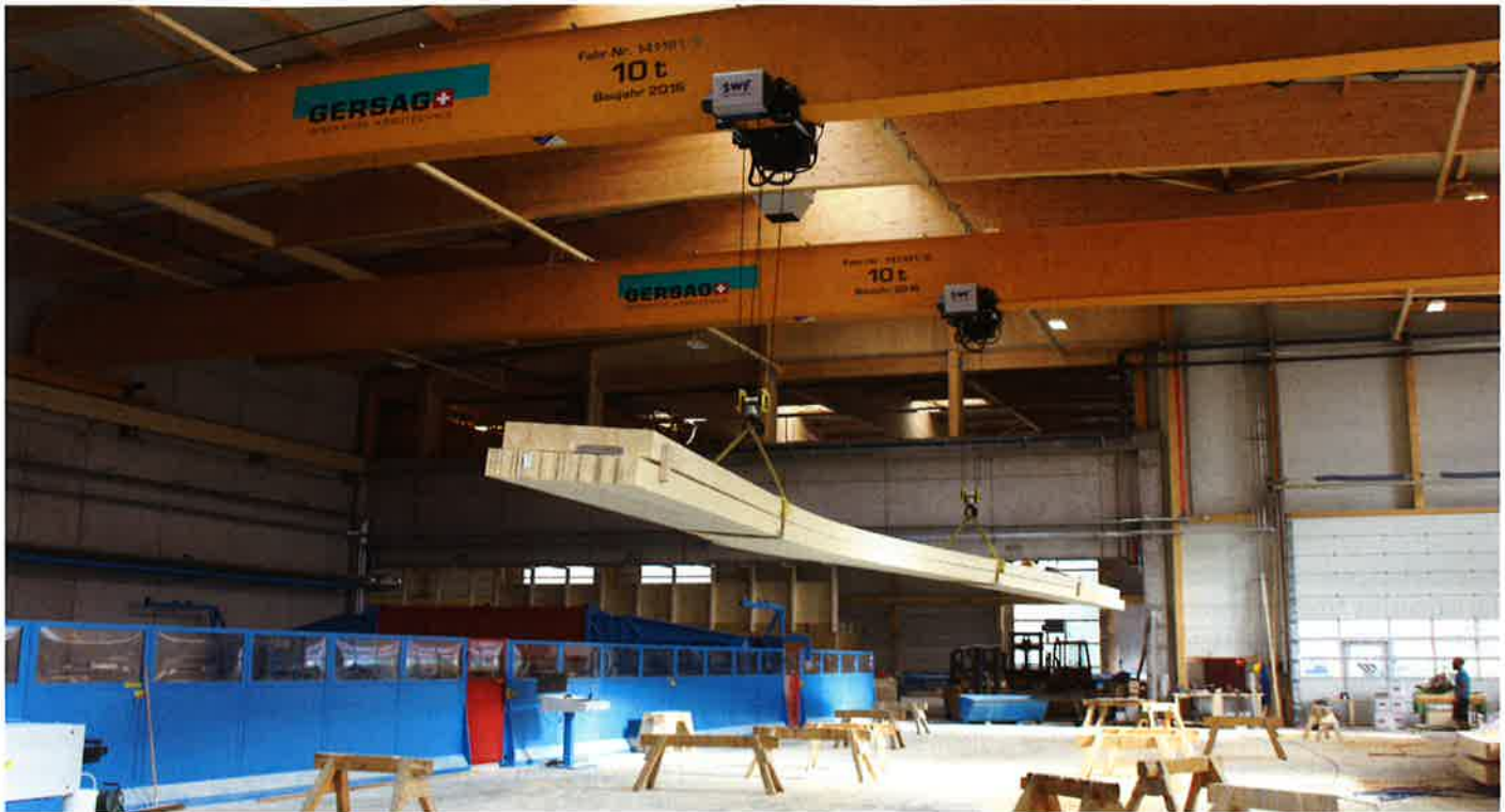
Die synchrone Steuerung von jeweils zwei Brückenkränen lässt das Heben und Verschieben von bis zu 35 Meter langen Teilen zu.
