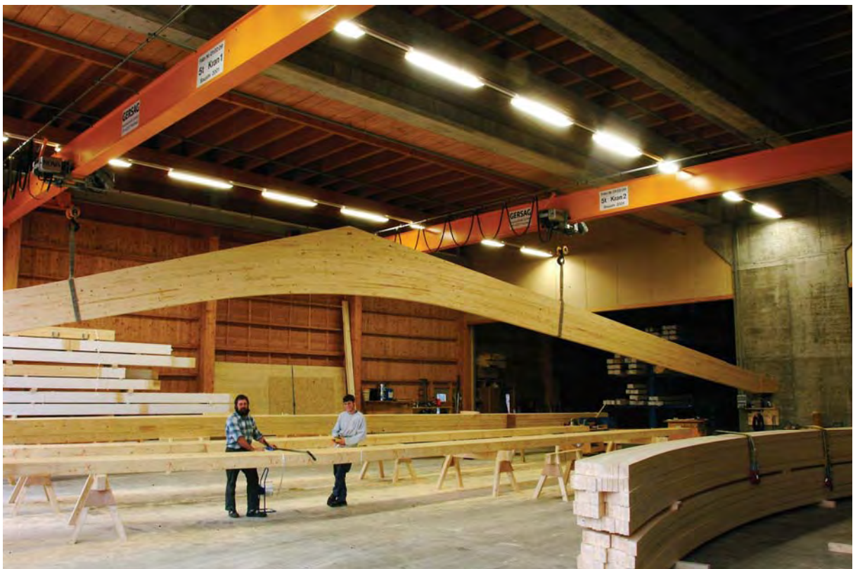
Zwei Deckenlaufkrane mit Tandemsteuerung
