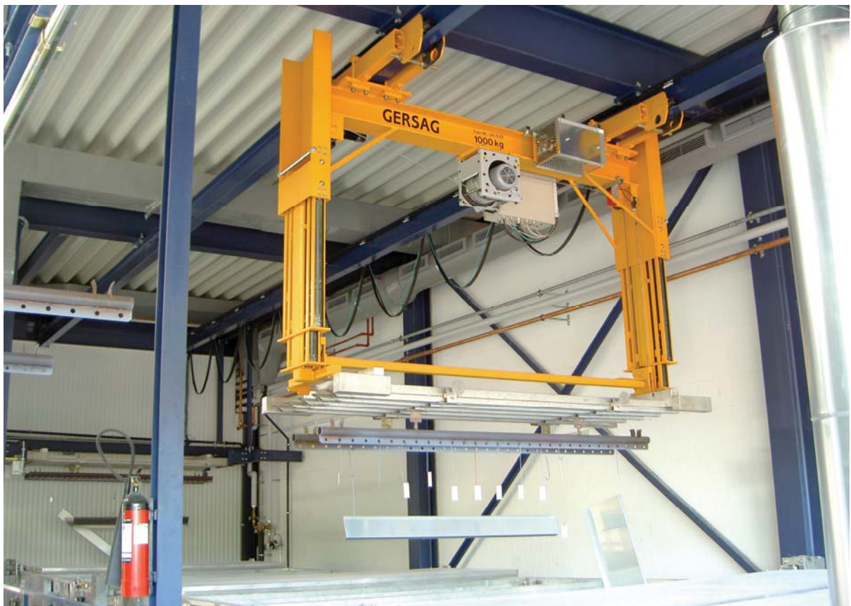
Automatischer Umsetzerkran bei der Firma Ernst Weber AG
