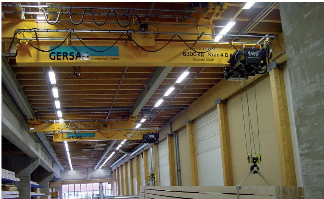
Ausfahrbare Kranbrücke bei der Firma Hüsser Holzleimbau AG
