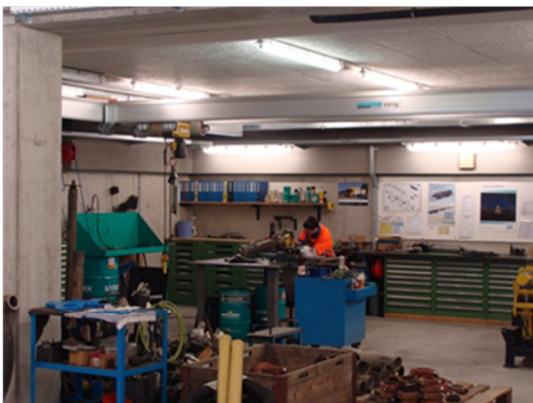
Mechanische Werkstatt mit dem Aluminium Leichtbausystem in gedrängter Bauart
