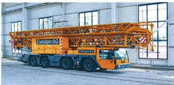
Liebherr MK 80 speziell für Elementmontage
