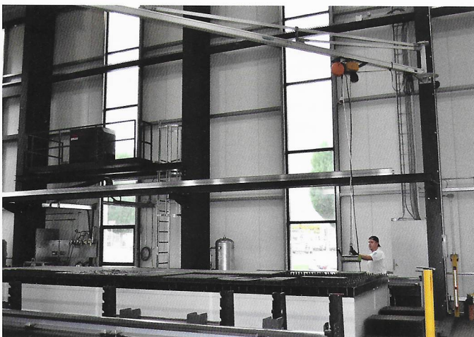
Transport von Kleinteilen nach dem Brennvorgang mit dem Aluminium Wandschwenkkran und Lastmagneten.
