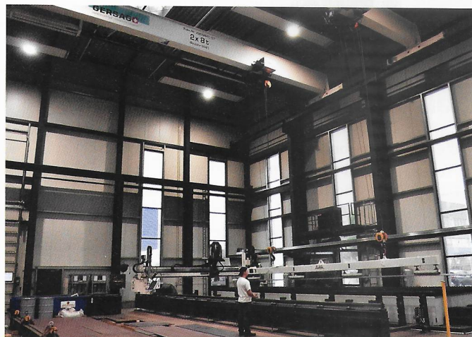
Magnettraverse beim Transport von Blechgurten.
