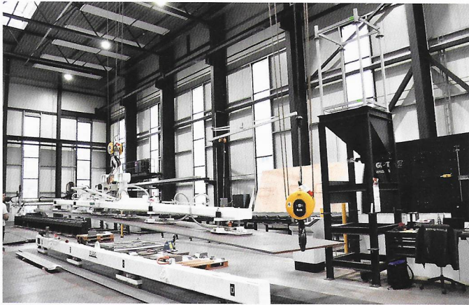
Elektrisches Vakuumgerät transportiert 12 m Blechplatte zum Plasmacenter.
