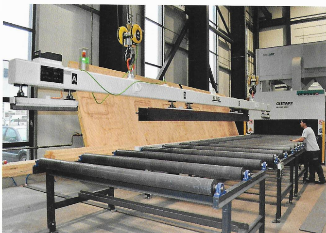
Aufnahme von Träger mit der Magnettraver
