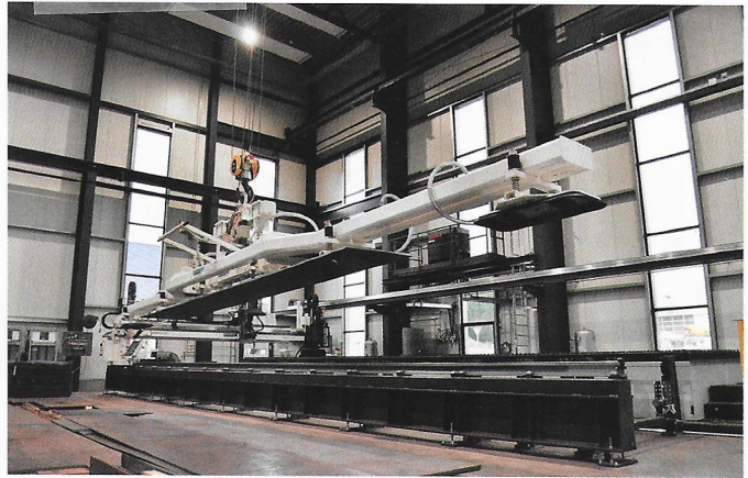
Transport einer 3 Meter Platte mit dem Vakuumgerät.
