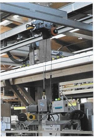
► Angenehmes Positionieren der mittelgroßen Deckplatten mit dem Vakuumgerät des Aluminium-Einträgerkrans
