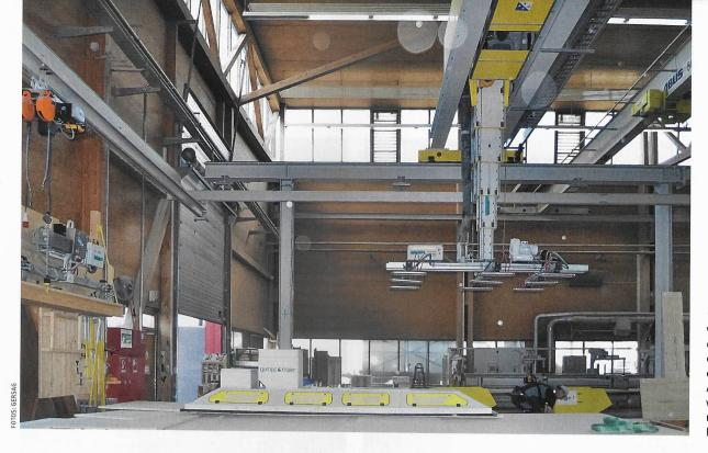
■ Die Wechselvorrichtung des Stapelkrans ermöglicht ein einfaches Austauschen von Vakuumaufnahme und Einblasplatte
